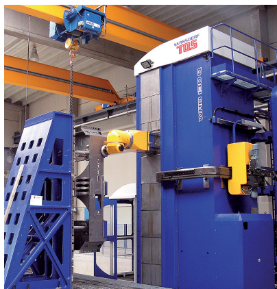
Horizontální vyvrtávačka WRD130 – dodavatel TOS Varnsdorf.
